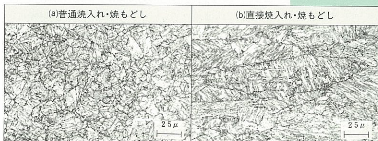
写真3 焼入れ・焼もどし法で製造した780N/mm 2 級高張力鋼板の顕微鏡写真
