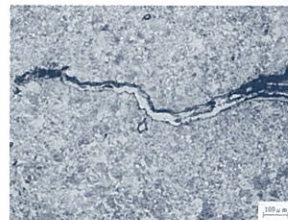
写真5 鍛鋼材異常部のマイクロ組織
