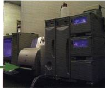
イオンクロマトグラフ装置(DIONEX製 DX-500 EG-40)
