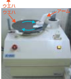
第9図 ウエハ自動前処理装置（全自動タイプ）の外観
