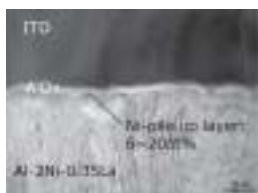
(a) ITO/Al-2at%Ni-0.35at%La 界面の断面TEM写真
