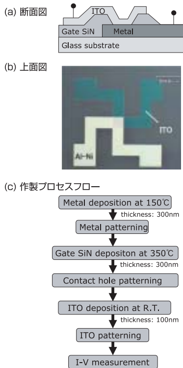
第3図 ITOとのコンタクト抵抗評価用ケルビンパターン
