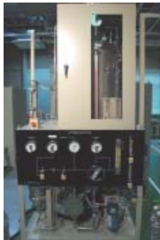
写真1 熱水ループ装置
