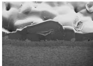
ウィスカ発生部の断面SIM観察
