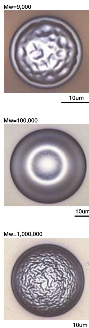
第7図 バックリングの分子量依存性 (初期体積 V_i \sim 0.5 [nl])
