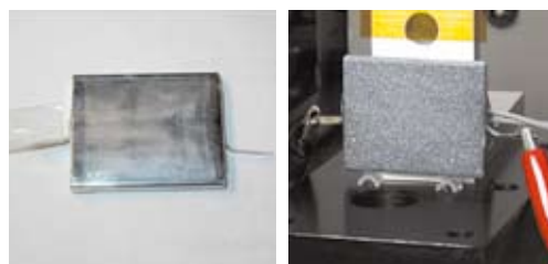
第9図 リチウムイオン電池の充放電時の変形計測
