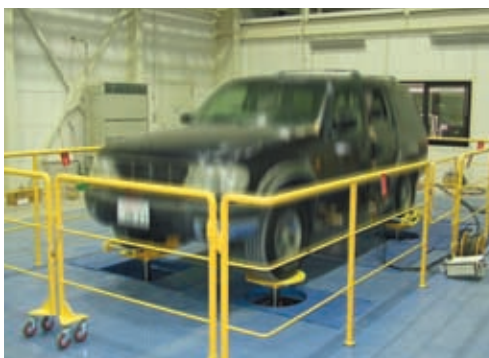
写真1 4Poster試験装置における加振状況
