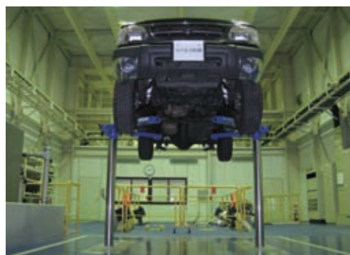
写真3 点検用リフタ
