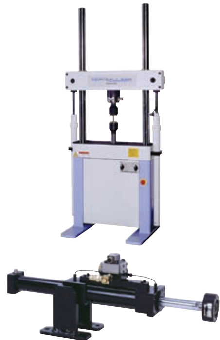
第1図 島津疲労・耐久試験機 E形シリーズ(上)と 島津コンパクト油圧加振機 JFシリーズ(下)*2)
