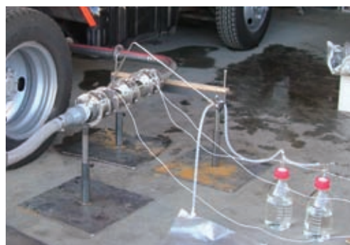
写真3 ディーゼル排ガスの性状調査状況
