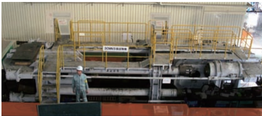
写真1 30MN横型引張試験機
