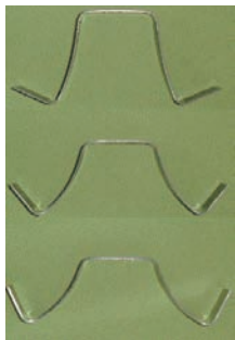
写真1 ハット成形体 上から590、980、1180MPa級ハイテン材
