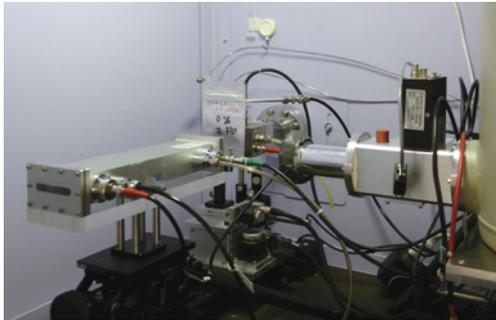
三元系リチウムイオン電池材料の評価にXAFSを用いた事例を第1図に示す。吸収端位置の高エネルギー側シフトからNi価数変化が、動径分布関数の変化からNi原子周辺の構造変化が確認された\*4)。この事例では事前に充電深度を変えた試料を測定したが、Alラミパックに封じたまま測定が可能であり(写真1)、充放電試験を行いながらの時分割データ取得も可能である。さらに検出器にX線カメラを用いることで情報領域を100 μ
