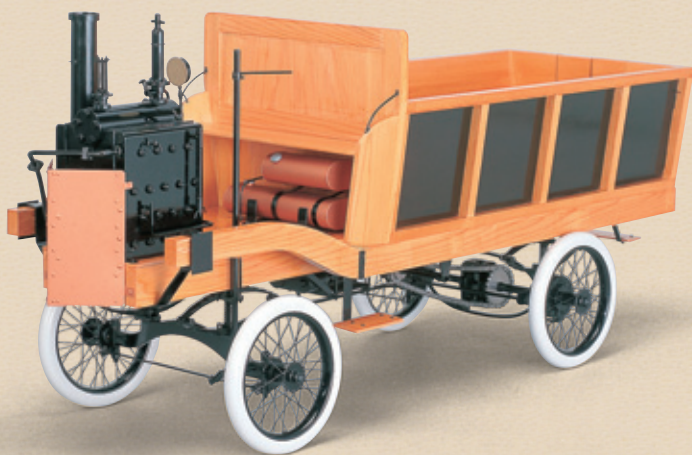
全長約4,500mm、全幅約1,800mm、全高約2,200mm、車両重量約900kg、蒸気エンジンレシプロ式、直列2気筒、スライド弁、最高出力25HP。現在、実物は残されておらず、トヨタ博物館(愛知県長久手市)に展示されている5分の1スケールの模型に、明治の技術者のものづくり気質をうかがうことができます
