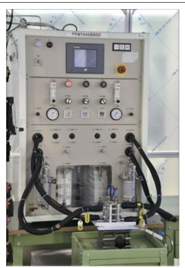
JARI標準セルの主な仕様 電極面積: 5×5cm 流路: サーペンタイン流路
