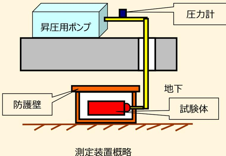
製品実体の耐圧性能、気密性能の評価が可能です。高压水素を用いた評価の場合には、協力会社での試験になりますが、高压ヘリウム、液圧での試験が可能です。また、試験体に内圧を負荷した状態で、外力負荷を与えて、どの程度の外力に耐えるかを評価する気密性（バースト）評価も可能です。負荷内圧は試験の安全性を考慮しながらご相談により決定いたします。
