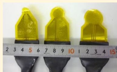
二重螺旋センサー 抵抗発熱および 抵抗測温が可能
