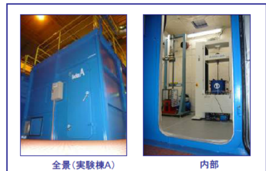
釘刺し試験装置の入った鋼鉄製チャンバ
