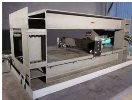
水平押し圧壊試験
