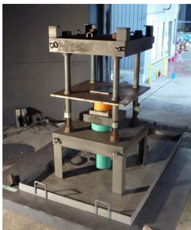
垂直押し圧壊試験
