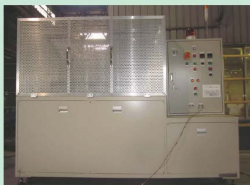
外部短絡試験装置
