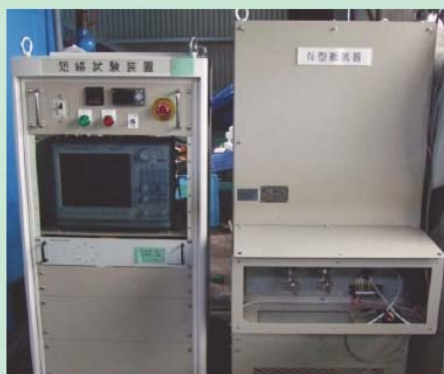
外部短絡試験装置
