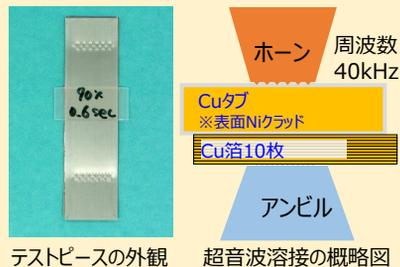
C-SAM Thru-scan法により、超音波溶接部の接合状況を非破壊で検査可能です。
