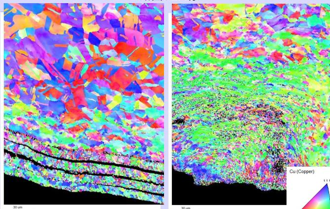
EBSDにより、結晶方位、配向性を評価することが可能です。「接合条件：良」は接合が進み、<101> が支配的に見られます。
