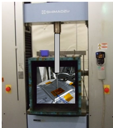
セル用釘刺し試験装置
