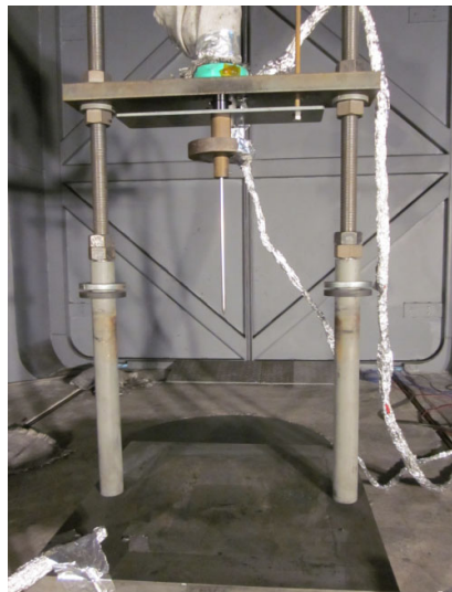
垂直型釘刺し試験装置
