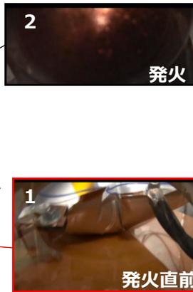
図 3Cレート過充電試験の挙動
