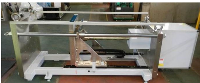
機械式水平圧壊試験機 （UN/ECE R100.02 Part2対応）
