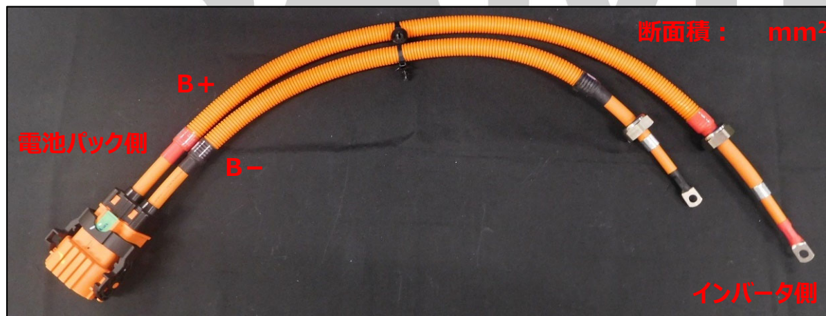
電池パック-インバータ間ケーブル
