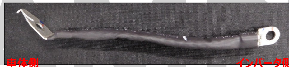
車体-インバータ間 (アース)ケーブル
