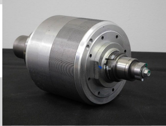
②ロータ取出し
