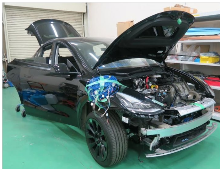
部品取り外し前の車両① (外観目視調査後に、車体解体／切断調査)
