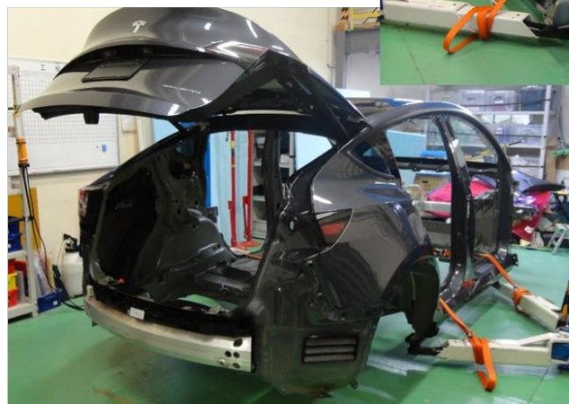
部品取り外し後の車両② (主にこの車両を外観目視調査)
