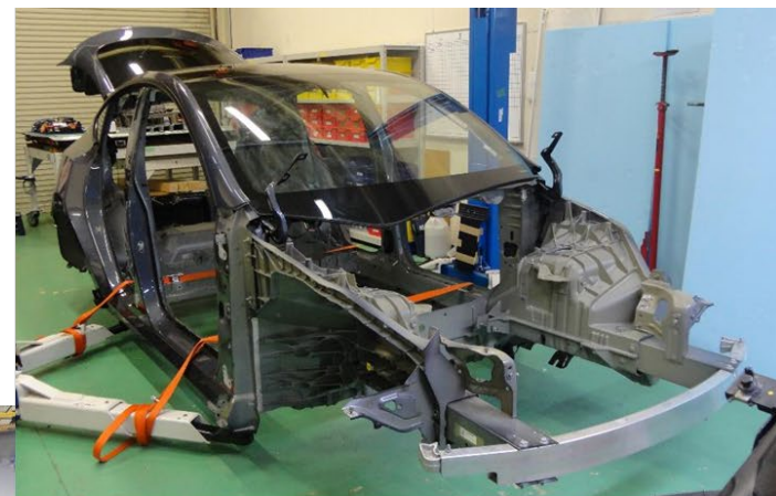
部品取り外し後の車両② (主にこの車両を外観目視調査)
