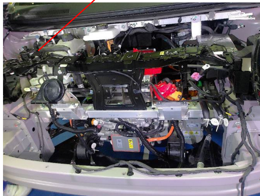
バンパとラジエータを外した状態
