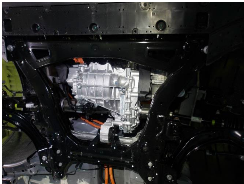
フレーム間に収まるモータAss'y 上が車両前
