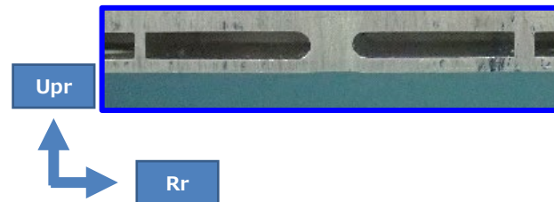
アンダーカバー接合部（A-A断面）
