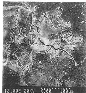
写真1 合金粉末で製造したTiAlターゲット材に見られた使用中の表面割れ
