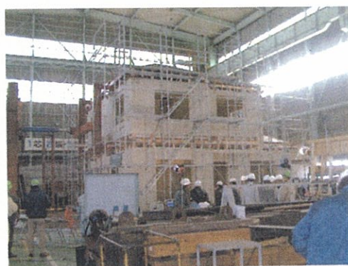
写真3 木造2階建住宅の水平耐力試験
