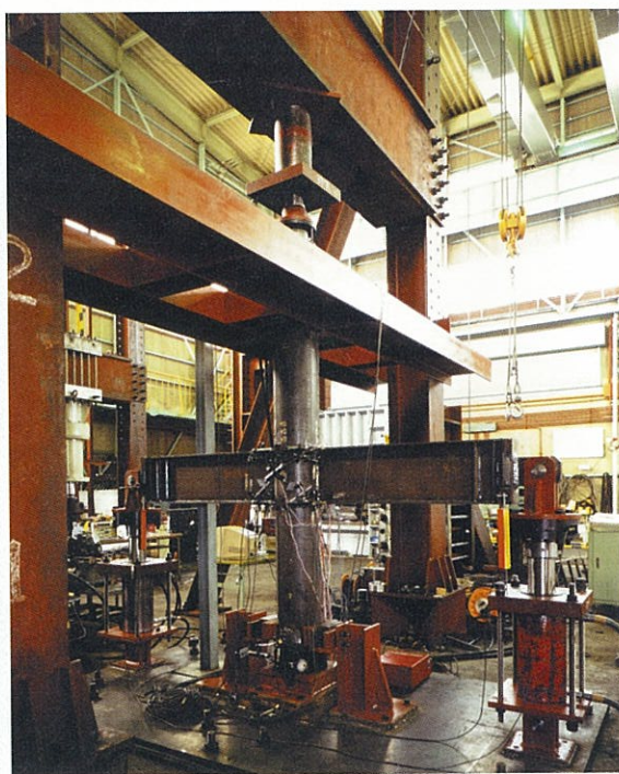
写真1 柱-はり接合部耐力試験
