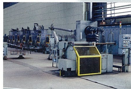
写真1 伸線加工性評価用伸線機の例 (24"-7頭連続伸線機)
