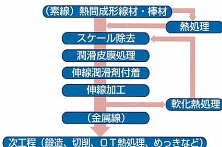
第1図 金属線の製造工程の概要
