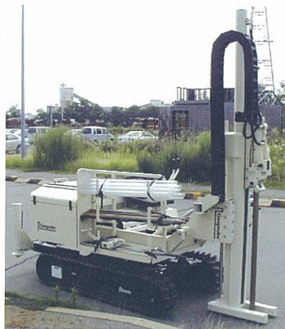
写真6 高効率深層部土壌サンプリング装置（ジオプローブ）
