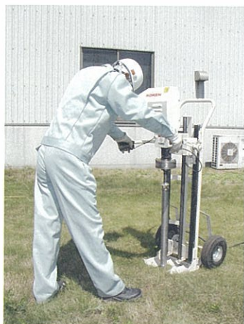
写真5 表層土壌採取機器（ネコドリル）
