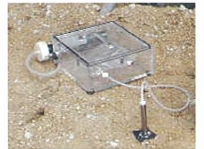
写真2 土壌ガス採取状況
