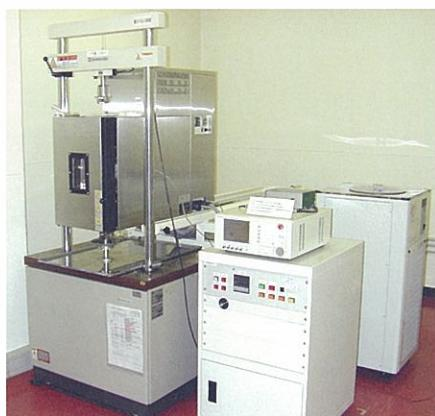
写真1 恒温・恒湿槽を新設した疲労試験機
