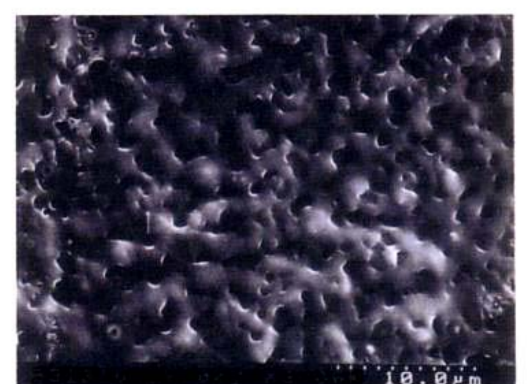
第5図 ポリエチレンの発泡処理事例 7) (SEM像)
