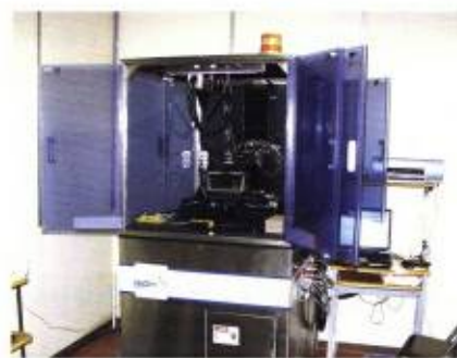
写真1 X線応力測定装置の外観(ラボスタイル)
