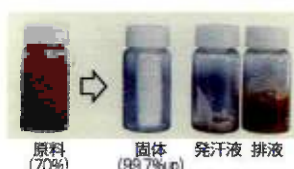
写真2 ナフタリンの分離精製
