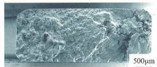
写真3 脱ガス材・欠陥部の軸疲労破面
