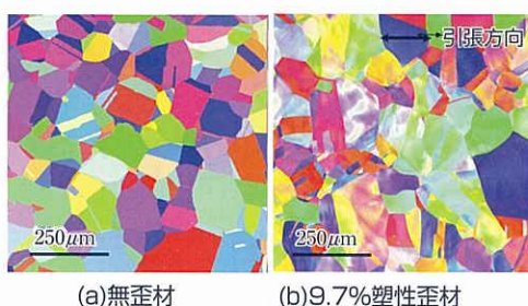
第3図 無歪および9.7%歪材の逆極点図方位 (IPF) マップ
