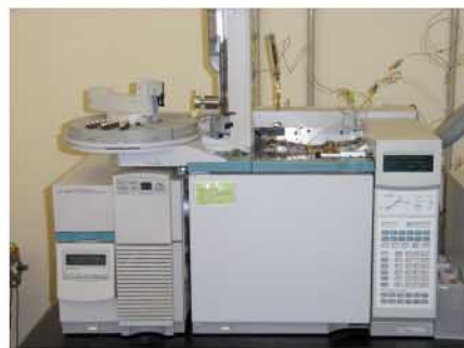
写真1 油性反応分析用GC-MS装置
