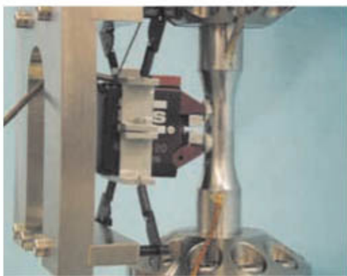
写真2 疲労試験の状況
