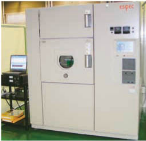
写真3 結露試験機能付き温度サイクル試験器
