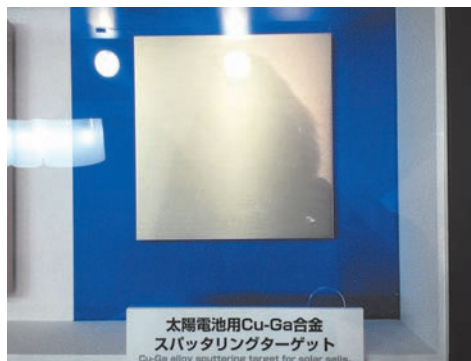
写真1 Cu-Gaターゲットの外観(230×230×10mm)
