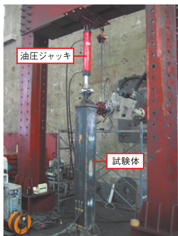
写真2 ハイブリッド試験状況 (橋脚の1/6スケールモデル)
