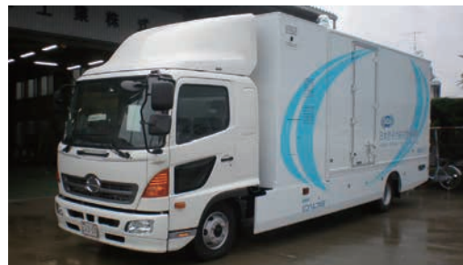
移動式ラボ (Ge半導体検出器搭載：放射能濃度測定が可能)
