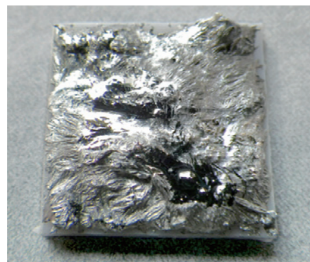
第1図 Al含有金属の外観(No.1: Al濃度5%)
