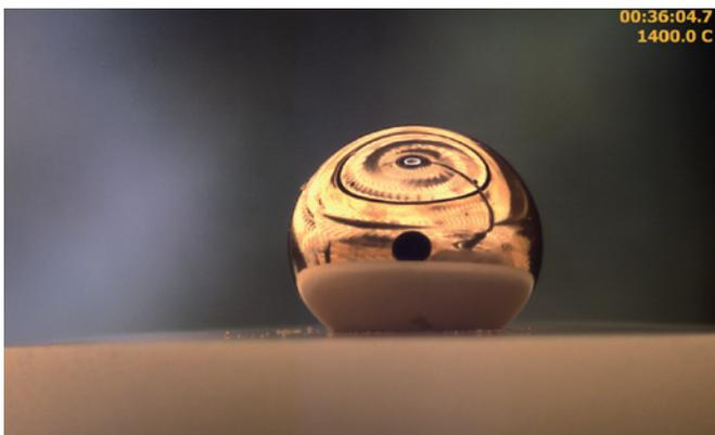
測定方法：静滴法 溶滴：純Au
