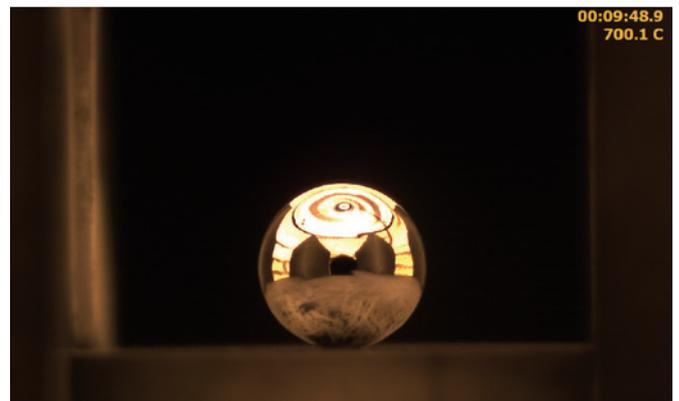
測定方法：押出液滴法 溶滴：純Al
