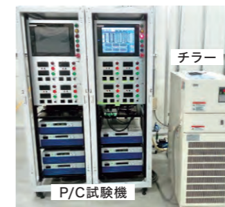
■写真1 パワーサイクル (P/C) 試験機 (本体)
