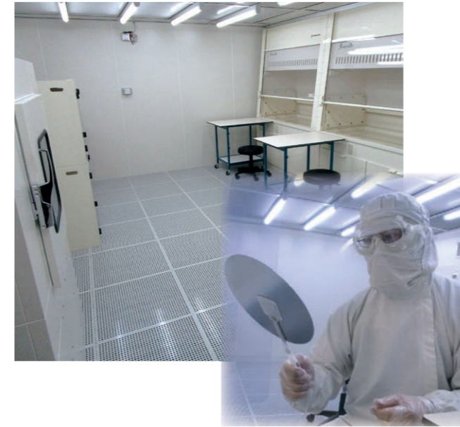
写真1 クリーンルームによるウェハ表面汚染分析
